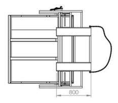
5 Encaixe para Lança de 800mm Comprimento
